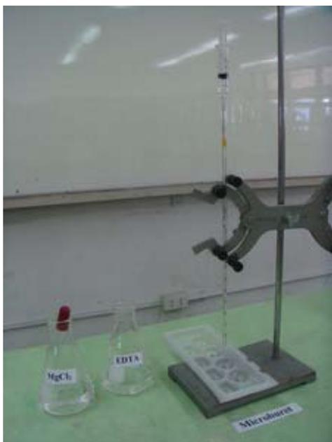
**Figure 1.** Microburet module
